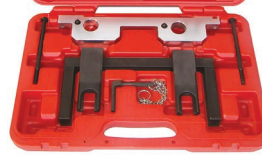
Инструмент для монтажа распредвала выпускных клапанов BMW N52, N51 ATA-4424
